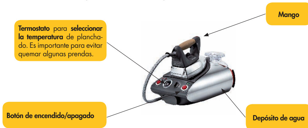
Fig. 4.8. Existe una gran cantidad de tipos de plancha. Las que tienen incorporado un depósito con agua consiguen una gran cantidad de vapor, con lo que se facilita mucho esta tarea doméstica.
